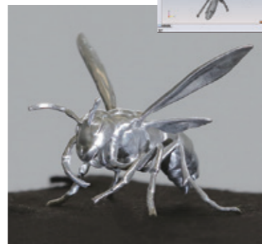
3次元CAD/CAMシステムと高性能の5軸・複合加工機を連携させて作成した複雑な形状の「蜂」の試作モデル
